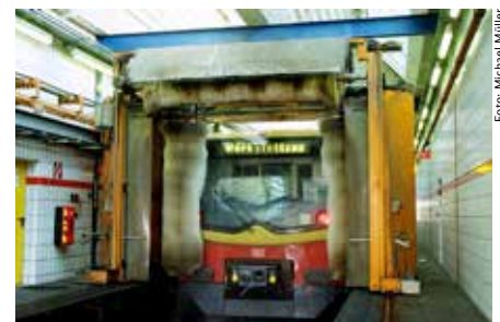
Für das gute Erscheinungsbild der S-Bahnzüge ist die Außenwäsche wichtig, die jeder Zug regelmäßig erhält. Hierfür gibt es in Wannsee ein gesondertes Waschgleis mit einer am Zug vorbeifahrenden Waschbürstenanlage (ähnlich einer Autowäsche). Ein Waschvorgang dauert rund 20 bis 30 Minuten.
